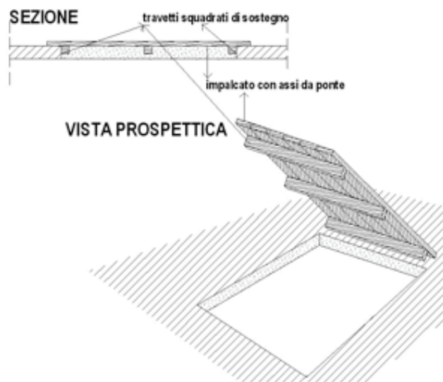
Immagine 22 Intavolato per chiusura buchi o forometri varie
