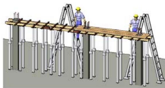
Immagine 02 Posa banchinaggio trave orizzontale
